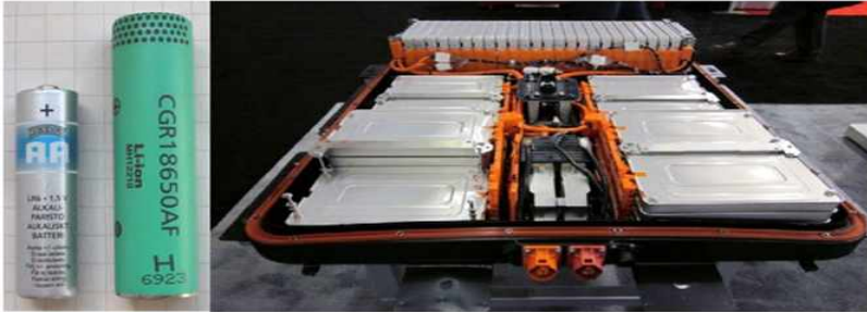
〈그림 3-9〉 알카라인 AA 배터리 셀, 테슬라의 리튬이온 배터리, 닛산의 배터리 모듈과 팩
